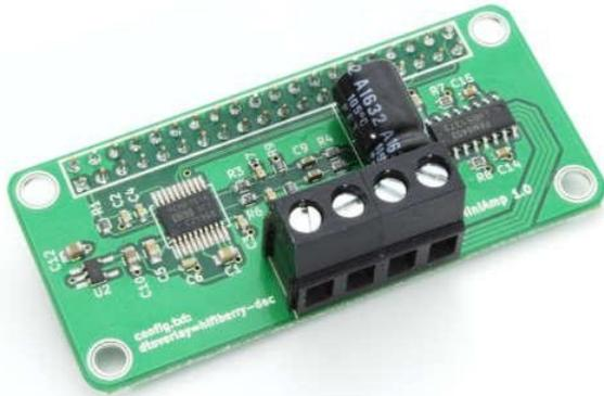
Dies ist HiFiBerrys kleinste Verstärkerplatine, entwickelt für den Raspberry Pi Zero. Es kann nicht nur mit dem Raspberry Pi Zero, sondern auch mit dem größeren Raspberry Pi B+/2 und 3 verwendet werden
