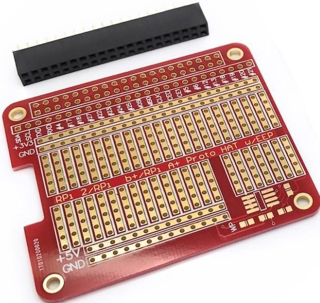
Mit diesem Prototyping Board für Raspberry Pi können Breadboard Aufbauten, permanent auf eine Leiterplatte übertragen werden.
