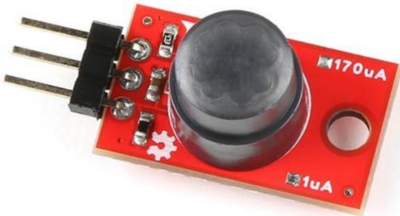
Passiv-Infrarot-Sensoren (PIR) sind ideal, um Bewegungen in einem kleinen Bereich um den Sensor herum zu erkennen. Das 170 $\mu$ A SparkFun EKMC4607112K PIR Breakout ist ein einfaches Board, das mit einem PIR-Sensor der EKM-Serie von Panasonic<sup>®</sup> ausgestattet ist. Die PIR-Sensoren der EKM-Serie sind für kleine Bewegungen optimiert und bieten Bewegungserfassungsoptionen für Anwendungen mit kontinuierlicher Stromversorgung.
