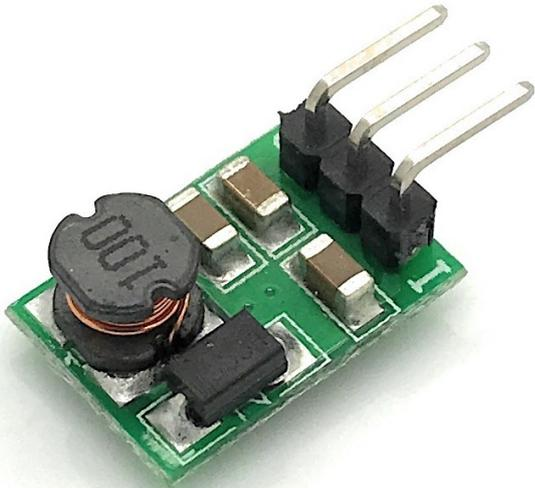
Kleiner Step-Down Converter mit einstellbarer Ausgangsspannung ideal für die Nutzung auf Breadboards.
