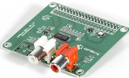
Der HiFiBerry DAC+ ist ein hochauflösender Digital-Analog-Wandler für den Raspberry Pi Model B+ und 2B. Dies ist eine spezielle Soundkarte für den Raspberry Pi, die für einen bestimmten Anwendungsfall optimiert ist: die beste Audio-Wiedergabequalität.
