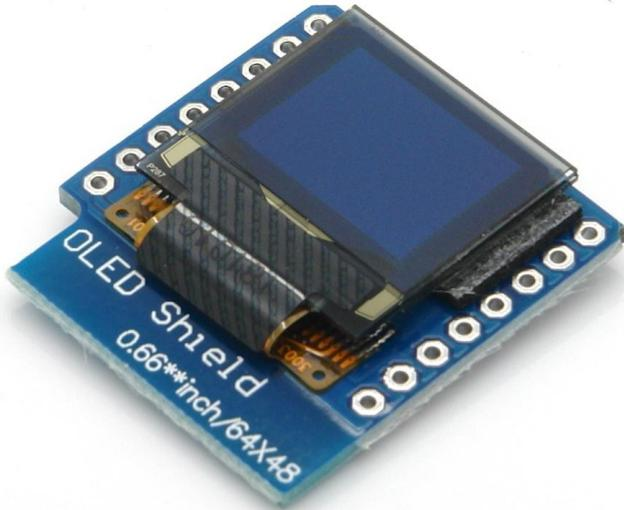
Dieses Shield erweitert den D1 Mini um ein OLED Display.
