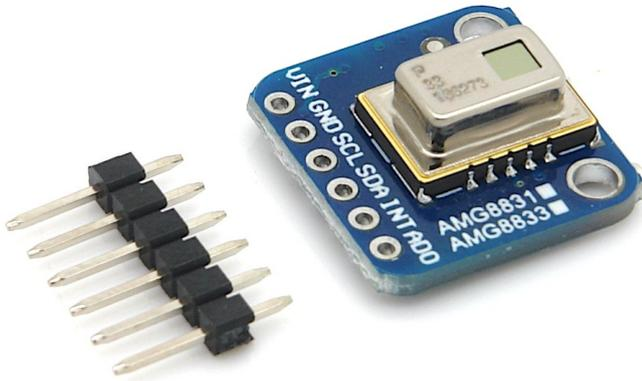
Dieser Sensor von Panasonic ist ein 8x8 Array von IR-Thermosensoren. Wenn er an einen Mikrocontroller (z.Bsp. Raspberry Pi) angeschlossen wird, gibt er ein Array von 64 einzelnen Infrarot-Temperaturmessungen über I2C zurück. Der Sensor ist mit einer Wärmebildkamera vergleichbar, jedoch kompakter und bereit für eine einfache Integration.
