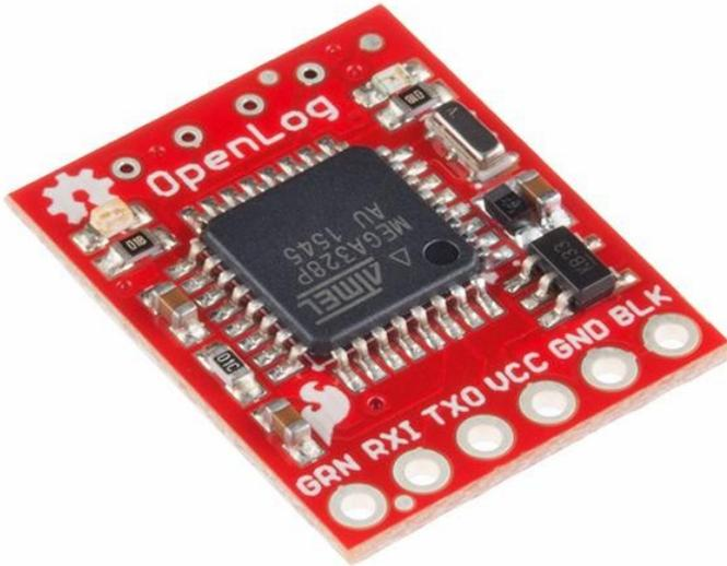
Der SparkFun OpenLog ist ein Open-Source-Datenlogger, der über eine einfache serielle Verbindung arbeitet und microSD-Karten bis zu 32 GB unterstützt. Der OpenLog kann große Mengen an seriellen Daten speichern oder "protokollieren" und als eine Art Blackbox fungieren, um alle seriellen Daten zu speichern, die Ihr Projekt für wissenschaftliche oder Debugging-Zwecke erzeugt.
