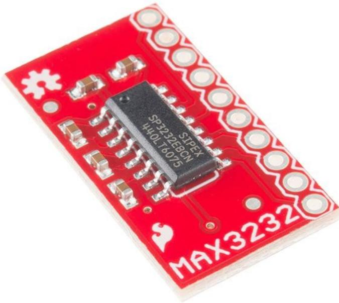
Das 'must have' IC für TTL/CMOS Projekte hat endlich sein eigenes Breakout Board! Dies ist der RS232-Wandler-IC, der bei 3V läuft und mit 5V-Logik kommunizieren kann.
