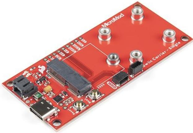
Das MicroMod Qwiic Carrier Board kann für schnelle Prototypen mit anderen Qwiic-Geräten verwendet werden. Der MicroMod M.2-Sockel bietet Anwendern die Freiheit, mit jeder Prozessorkarte im MicroMod-Ökosystem zu experimentieren. Dieses Board verfügt außerdem über zwei Qwiic-Anschlüsse und vier 4-40-Schraubeneinsätze zum Anschluss und zur Montage von Qwiic-Geräten.
