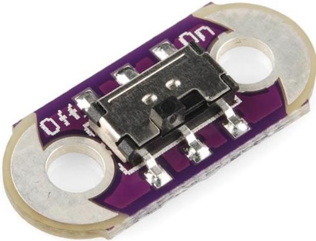
Dies ist ein einfacher Schiebeschalter für das LilyPad. Verwenden Sie es als eine einfache ON/OFF-Schalter, oder um LEDs, Summer, Sensoren, etc. zu steuern. Die Schalter auf jeder Platine sind für 4 Volt bei 300mA ausgelegt, funktionieren aber auch bei 5 Volt mit einer Reduzierung des Stroms.
