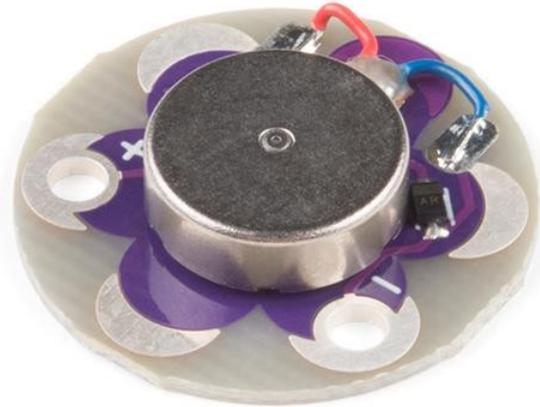
Legen Sie 5 V an und lassen Sie sich von diesem kleinen, aber starken Vibrationsmotor schütteln. Funktioniert großartig als physischer Indikator, ohne jemanden außer dem Träger zu benachrichtigen. Diese Version verwendet einen oberflächenmontierten Motor, der während des Gebrauchs weniger wahrscheinlich beschädigt wird.
