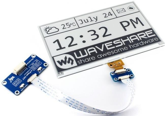
Dies ist ein E-Ink-Displaymodul, 7,5 Zoll, 800x480 Auflösung, mit integriertem Controller, der über die SPI-Schnittstelle kommuniziert und partielle Aktualisierung unterstützt.
