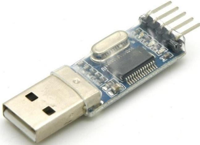
Mit diesem Adapter wird über ein Terminalprogramm am PC oder Mac der Zugriff auf den Raspberry Pi oder einen Mikrocontroller ermöglicht. Außerdem stellt der Adapter auch eine Stromversorgung zur Verfügung.
