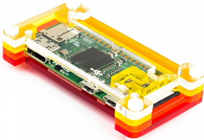
Passendes Gehäuse für Raspberry Pi Zero v1.3.
