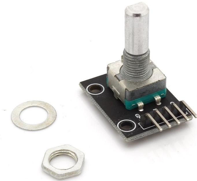
Dieses Breakoutboard mit Encoder eignet sich ideal um Einstellungen z.B. an einem Raspberry Pi oder Arduino vorzunehmen. Außerdem kann der Regler auch gedrückt werden um z.B. einen Menüpunkt auszuwählen.
