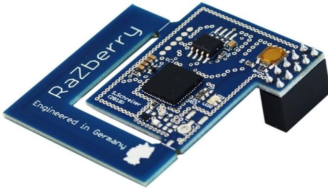
Mit dem Z-Wave.Me RaZberry verwandeln Sie den Raspberry Pi in ein Z-Wave Smart Home Gateway. Hardware und vorkompilierte Z-Wave Controller Software können mit einer eigenen Benutzeroberfläche versehen werden.
