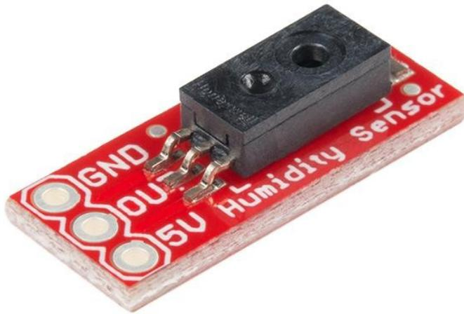
Dies ist eine Breakout-Platine für den Feuchtigkeitssensor HIH-4030 von Honeywell. Der HIH-4030 misst die relative Luftfeuchtigkeit (%RH) und liefert sie als analoge Ausgangsspannung. Sie können den Ausgang des Sensors direkt an einen ADC auf einem Mikrocontroller anschließen; und dank des nahezu linearen Spannungsausgangs des Sensors sind die Daten sehr einfach zu verarbeiten.
