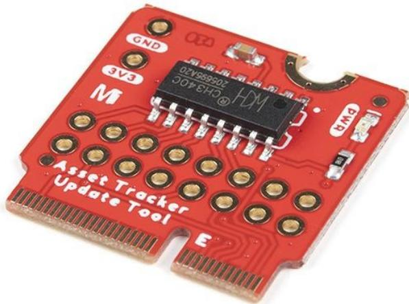
Das SparkFun MicroMod Update Tool wurde für die Schnittstelle zum MicroMod Asset Tracker Carrier Board entwickelt und ermöglicht auch die direkte Kommunikation mit dem u-blox SARA-R510M8S Modul unter Verwendung der hochentwickelten m-center Cellular Evaluation Software von u-blox. Wenn Sie mit u-center, der GNSS-Evaluierungssoftware von u-blox, vertraut sind, wissen Sie, wie exzellent deren Software ist. m-center steht dem in nichts nach. Schließen Sie ein USB-C-Kabel an und los geht's!
