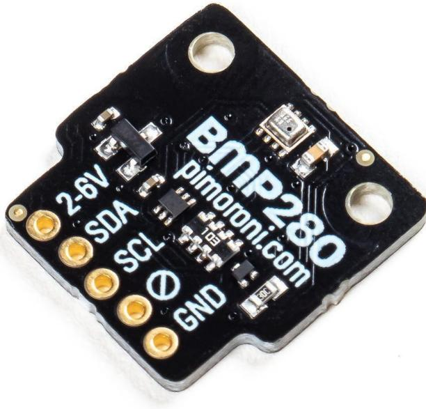
Ein schneller und präziser Umweltsensor, der Temperatur, Druck und Höhe messen kann. Unser BMP280-Breakout ist Raspberry-Pi und Arduino-kompatibel.
