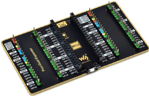
Dieser Dual-GPIO-Expander für den Raspberry Pi Pico, ermöglicht den parallelen Anschluss von bis 2 Erweiterungsboards. Die farbige Kodierung sowie die Beschriftung der Pins, sorgt für übersichtliches und einfaches arbeiten.
