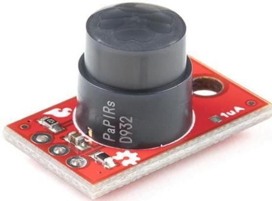
Passiv-Infrarot-Sensoren (PIR) eignen sich hervorragend zur Erkennung von Bewegungen in einem kleinen Bereich um den Sensor herum. Das 1 $\mu$ A SparkFun EKMB1107112 PIR Breakout ist ein einfaches Breakout, das mit einem PIR-Sensor der EKM-Serie von Panasonic ausgestattet ist. Die PIR-Sensoren der EKM-Serie sind für kleine Bewegungen optimiert und bieten aufgrund des sehr geringen Standby-Stromverbrauchs (1 $\mu$ A) Bewegungserkennungsoptionen für batteriebetriebene Anwendungen.
