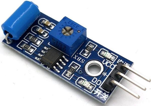
Dieser Vibrationssensor mit LM393 Chip eignet sich ideal für den Einsatz mit dem Raspberry Pi oder Arduino. Viele Anwendungsmöglichkeiten sind denkbar: Beispielsweise automatisches Ein- und Ausschalten von Geräten bei Vibration oder Erschütterung, oder als digitaler Sensor, um die Aktivierung eines Gerätes zu überwachen (Garagentor, Waschmaschine, etc).
