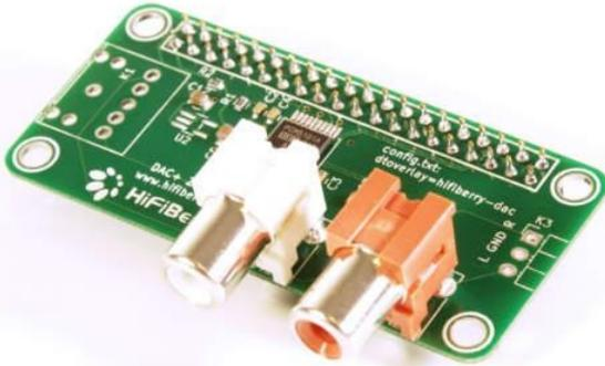
Dies ist HiFiBerrys kleinstes Board im Raspberry Pi Zero Formfaktor. Es kann nicht nur mit dem Raspberry Pi Zero, sondern auch mit den größeren Raspberry Pi B+/2 und 3 verwendet werden.
