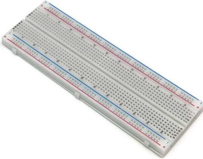
Dieses Breadboard erlaubt es schnell einfache fliegende Schaltungen aufzubauen. Es können auch mehrere Breadboards aneinandergereiht werden.
