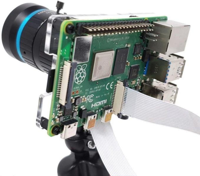
Diese Mounting Plate ist eine einfache und kostengünstige Lösung zur Montage eines Raspberry Pi an der Raspberry Pi High Quality-Kamera.
