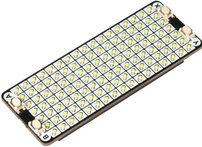
Ein funkelndes 7x17-Gitter aus eng gepackten, einzeln ansteuerbaren weißen LEDs, um Ihren Raspberry Pi Pico zum Leuchten zu bringen, begleitet von einem Quartett nützlicher Tasten. Das Pico Scroll Pack enthält 119 weiße LEDs in einer übersichtlichen 7x17-Matrix, zusammen mit vier taktile Tasten zur Interaktion mit Ihrem Pico-basierten Gerät.
