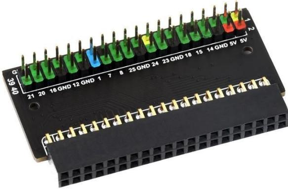
Diese auf den Raspberry Pi 400 zugeschnittene Erweiterung macht die GPIO-Pins in einer aufrechten Form (wie bei den übrigen Pi-Modellen) verfügbar und bietet eine Farbkodierung der verschiedenen Pins.
