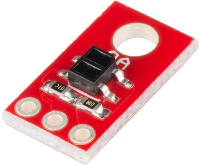
Diese Version der Breakout-Platine QRE1113 verfügt über einen einfach zu bedienenden Analogausgang, der in Abhängigkeit von der Menge des zum Sensor zurück reflektierten IR-Lichts variiert. Diese winzige Platine ist perfekt für Line-Sensing-Anwendungen und kann sowohl in 3,3-V- als auch in 5-V-Systemen verwendet werden.
