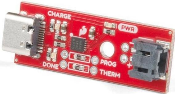
Der SparkFun LiPo Charger Plus ist die verbesserte Leistungsoption in der SparkFun-Linie der einzelligen Lithium-Polymer (LiPo)-Akkuladegeräte. Bei dieser Iteration haben wir den Eingangsladeanschluss auf USB-C geändert und eine Auswahl der Laderate sowie einen optionalen Wärmeschutz bereitgestellt. Lade-, Strom- und Fertig-LEDs zeigen deutlich den Status des Ladevorgangs an. Diese Platine kann für alle von uns angebotenen einzelligen LiPo-Akkus mit 2-poligem JST-Anschluss verwendet werden.
