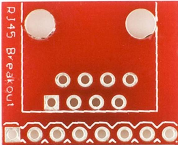
RJ45-Stecker sind die Art, die für Ethernet-Buchsen verwendet werden, aber sie machen große Allzweck-Stecker, wenn Sie eine Menge von Leitern benötigen. Dies ist eine kleine Platine, die die Pins des RJ45-Steckers auf eine 0,1"-Fläche bringt. Verwenden Sie sie mit abbrechbaren Headern für das Breadboarding oder erstellen Sie Ihr eigenes RJ45-Kabel. Sehen Sie sich die zugehörigen Artikel für Ethernet-Kabel und -Stecker an, die dazu passen!
