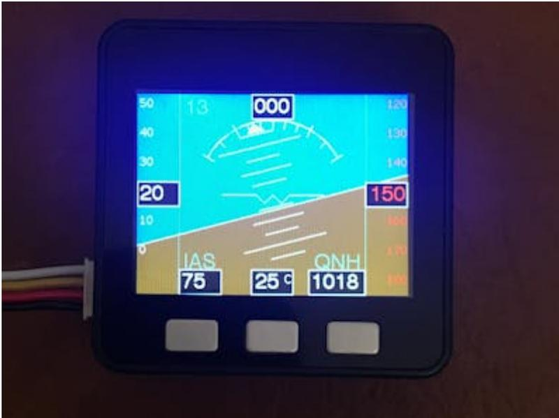
[M5stack basiertes PFD \(Primary Flight Display\)](#)
