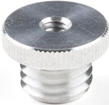
Dieser Aluminiumadapter konvertiert das weit verbreitete 1/4"-Gewinde von Kamera-Drei- und Einbeinstativen in das 5/8"-11-TPI-Gewinde (Gewinde pro Zoll) von hochwertigen Vermessungsantennen und -geräten. Er ist ideal für die Montage von RTK-Vermessungsantennen auf einem Einbeinstativ oder Dreibeinstativ.
