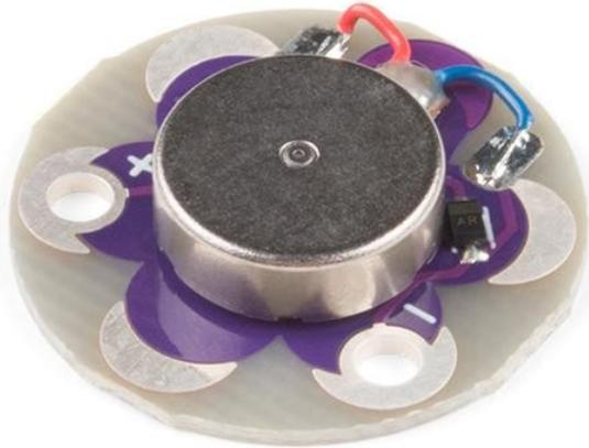
Legen Sie 5 V an und lassen Sie sich von diesem kleinen, aber starken Vibrationsmotor schütteln. Funktioniert großartig als physischer Indikator, ohne jemanden außer dem Träger zu benachrichtigen. Diese Version verwendet einen oberflächenmontierten Motor, der während des Gebrauchs weniger wahrscheinlich beschädigt wird.
