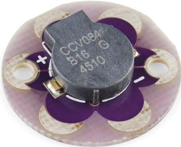
Dies ist ein kleiner Buzzer für das LilyPad-System. Verwenden Sie 2 E/A-Pins auf der LilyPad-Hauptplatine und erzeugen Sie verschiedene Geräusche basierend auf der unterschiedlichen Frequenz des E/A-Toggles. Laut genug, um in einer Tasche zu hören, aber nicht aufdringlich laut.
